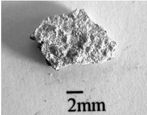
Εικ.3: Δείγμα A16. Στην επιφάνεια φαίνεται στρώμα από οξείδιο του μολύβδου.
